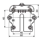
Der Wandrahmen wird an die Wand gehalten, und die Löcher zur Befestigung des Rahmens werden markiert. Das Bohren der Löcher, die Lochgröße und die Wahl der Befestigungsschrauben sind vom Wandmaterial abhängig.
